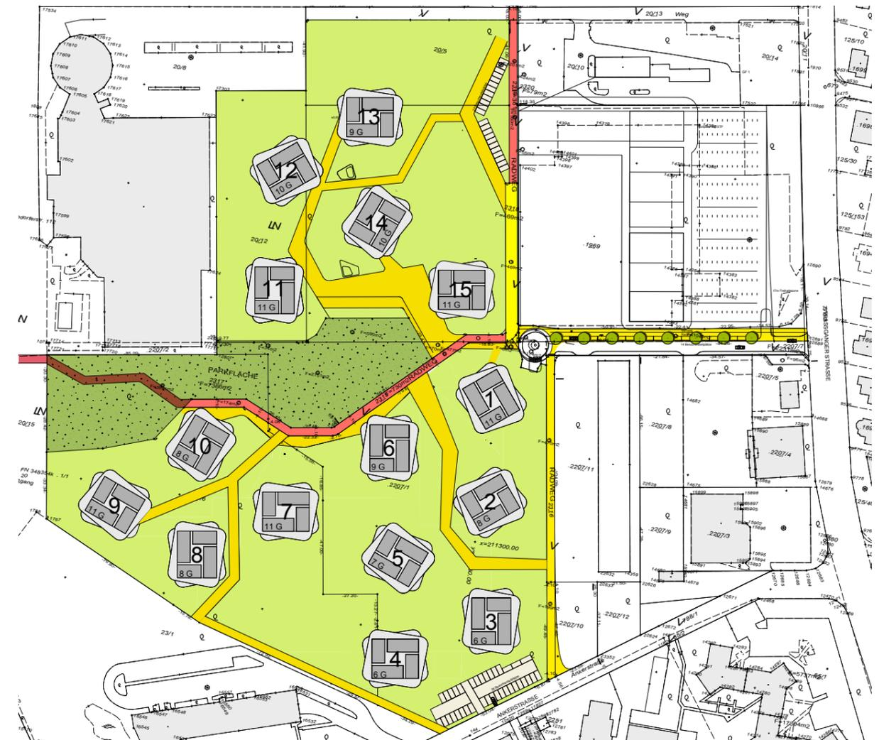
Abbildung 3: Fußwegeerschließung der Green City mit Anbindung in alle Richtungen (in rot und gelb dargestellt)
