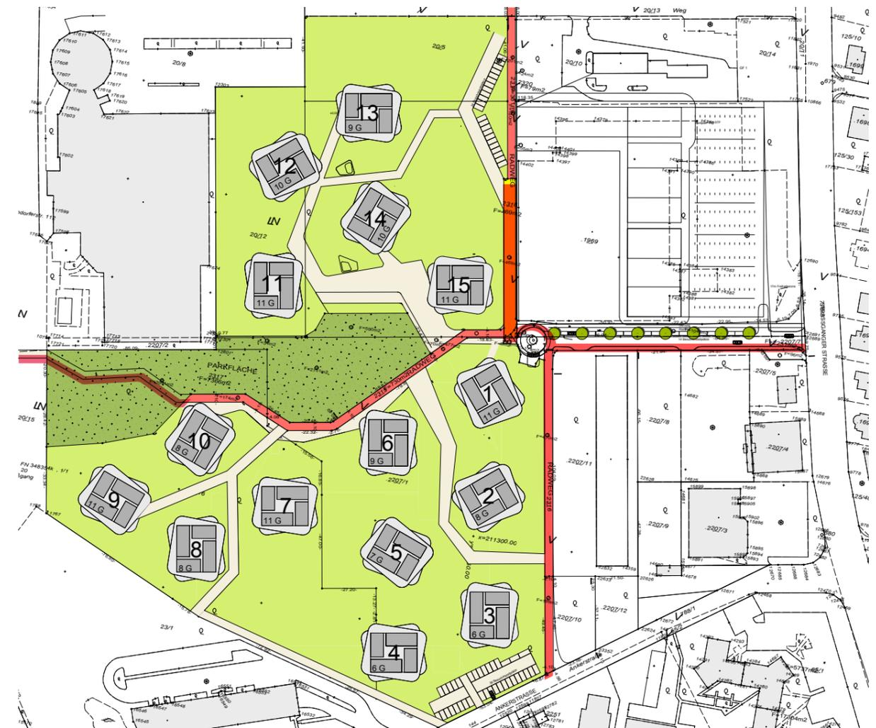
Abbildung 7: Radwegeerschließung der Green City mit Anbindungen in alle Richtungen (in rot dargestellt)
